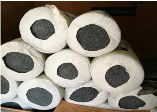
Fig. 5 / Isolation grâce à des jeans recyclés. ©MarcBarra
