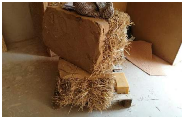
Fig. 4 / Bottes de paille porteuses utilisées pour la construction de l'école des Boutours ©MarcBarra
